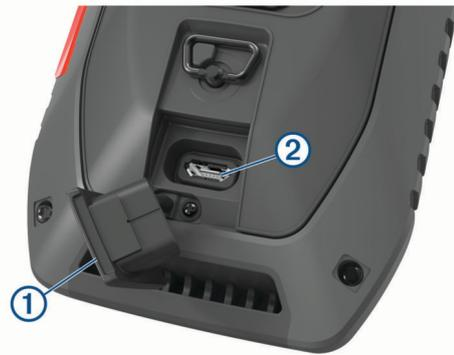
2 Stecken Sie das schmale Ende des USB-Kabels in den Mini-USB-Anschluss ② am Gerät.
